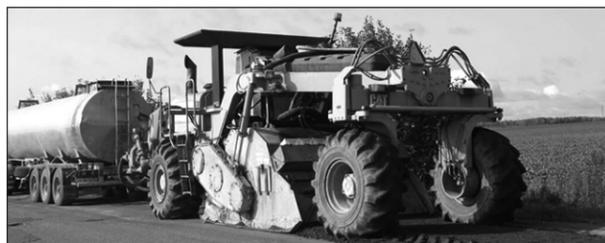
ся материал измельчают и смешивают со связующими материалами для получения однородного, прочного и износостойкого покрытия.
